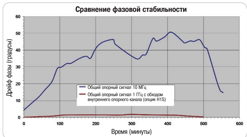
Рисунок 12 - Сравнение фазового дрейфа генераторов PSG с синхронизацией опорным сигналом с частотой 10 МГц и опорным сигналом с частотой 1 ГГц (опция H1S).
