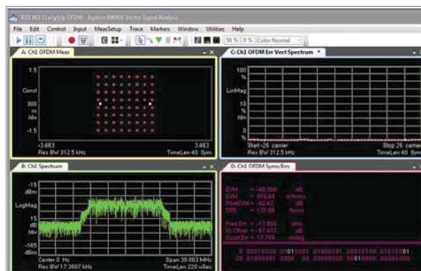
Рисунок 8 - До возникновения помехи: диаграмма созвездия сигнала формата OFDM (слева сверху), модуль вектора ошибки EVM (справа сверху) и спектр (слева внизу) в норме.
