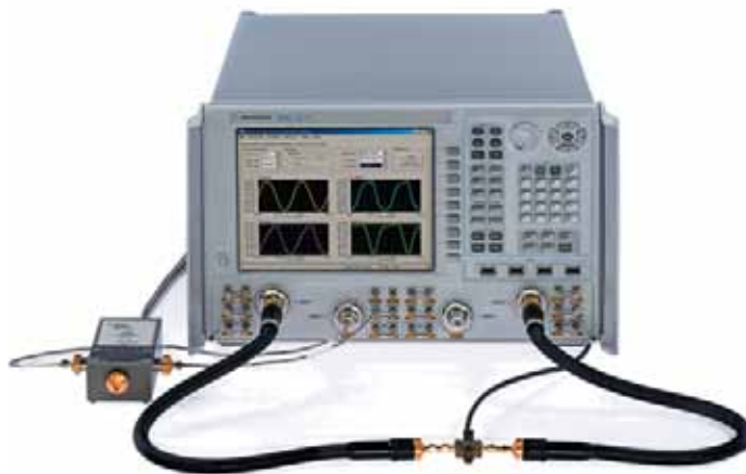
Рис. 3. ПО нелинейного векторного анализа, предназначенное для использования в анализаторе цепей PNA-X компании Agilent, представляет новый промышленный стандарт анализа нелинейных ВЧ/СВЧ цепей в диапазоне от 10 МГц до 50 ГГц. Это позволяет инженерам измерять X-параметры в полном объеме.
